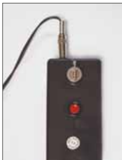
Abb. 21: Batteriebetriebene Zündvorrichtung für Kanone mit elektrischer Zündung
