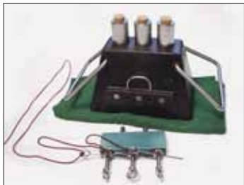
Abb. 22: Dreirohriger Standböller mit mechanischer Zündung und Abzugsleine
